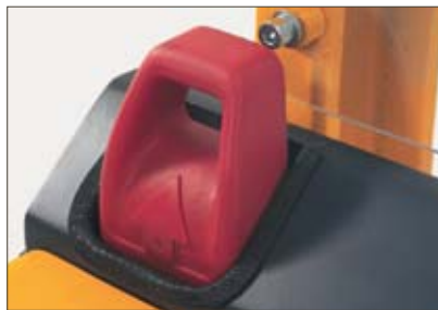
Coupe-batterie de sécurité facilement accessible
