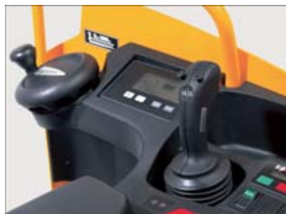
Commande de toutes les fonctions de translation et de levée à partir de la commande multifonctions pour le ESE 220/320
