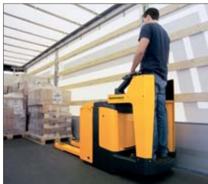
Protection du poste de conduite grâce à la plate-forme fixe
