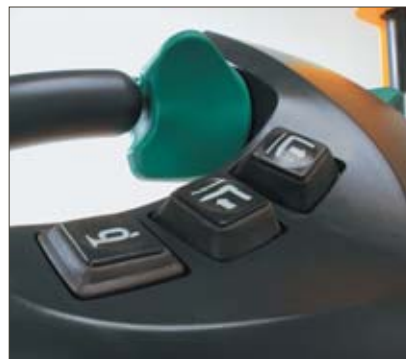
Boutons-poussoirs de levée et descente en douceur et avertisseur sonore
