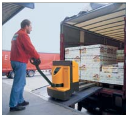
Stabilité de la translation grâce aux galets porteurs suspendus
