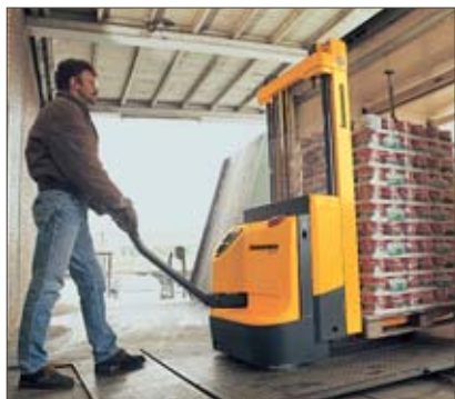
Passage d'un pont de chargement avec l'EJC Z
